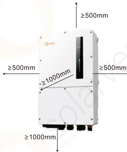
Малюнок 3.5 Монтажні зазори інвертора
