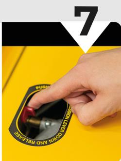
Поверніть ключ запалення в положення "START" та утримуйте ключ в цьому положенні кілька секунд. Через 2-3 секунди, не відпускаючи ключ запалення, відпустіть важіль декомпресора. Після того як двигун запуститься, відпустіть ключ запалення, він повернеться в положення "ON"
