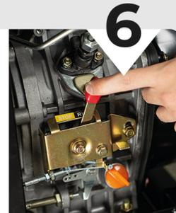
На верхній частині генератора утримуйте важіль декомпресора в натисненому положенні.
